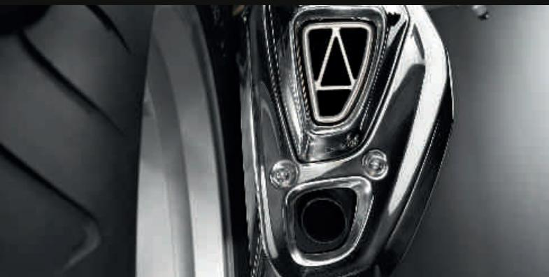
Auspuffsystem mit hochglanzverchromtem Schalldämpfer. Eine servobetätigte Auspuffklappe optimiert die Drehmomentabgabe.
