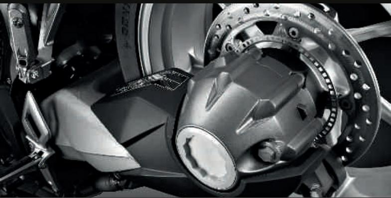
Wartungsfreier und reaktionsarmer Kardanantrieb mit versetzten Drehachsen, mehreren Ruckdämpfern und homokinetischem Gelenk.
