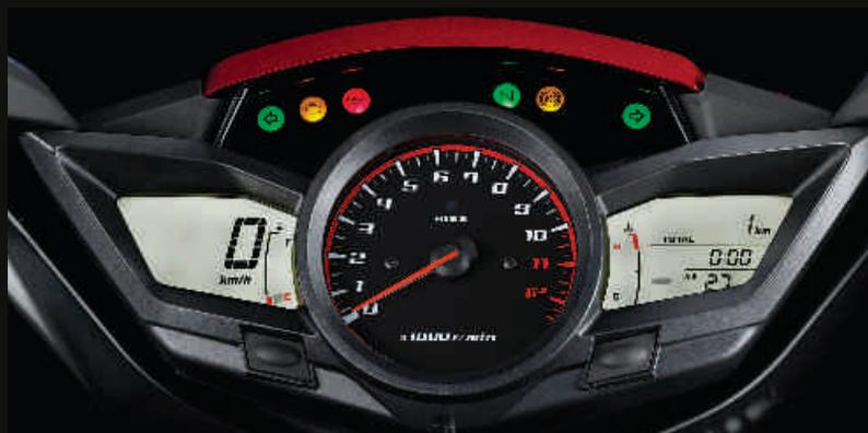
Instrumente mit Drehzahlmesser, Digital-Tachometer, Ganganzeige, Tankuhr, Kühltemperatur und weiteren praktischen Anzeigen.
