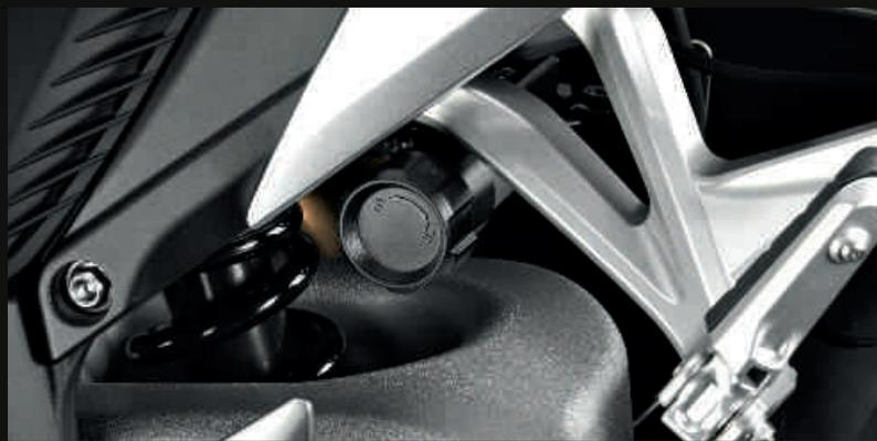
Einarmschwinge mit Pro-Link-Stoßdämpfer. Die Federvorspannung ist über ein Handrad bequem einstellbar.
