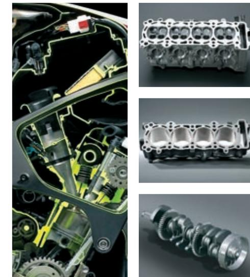
1. **PGM-DSFI** – Die dual-sequentielle, elektronische PGM-DSFI-Benzineinspritzung mit zwei Einspritzdüsen pro Zylinder verhilft dem Motor zu geschmeidiger, bestens dosierbarer Kraftentfaltung und trägt so zu perfekter Kontrollierbarkeit bei.
