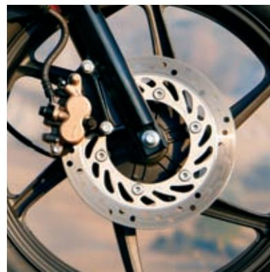
Für souveräne Bremskontrolle sorgen eine große Bremsscheibe mit Doppelkolbenbremszange vorn und eine zuverlässige Trommelbremse hinten.
